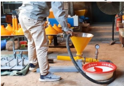
Bơm mồi, đặt vòi bơm lên miệng phễu
