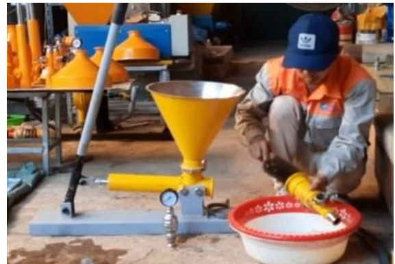
Tháo và vệ sinh tất cả thiết bị
